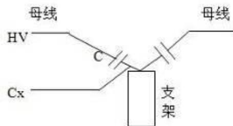
图 14 断路器断口电容试验接线
