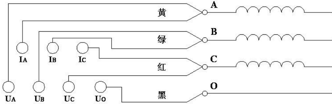
选择好测量电流，接好三相接线，在初始界面状态下按“测量”键后，直阻仪进入测量状态，开始给绕组供电。并进入如下界面：
