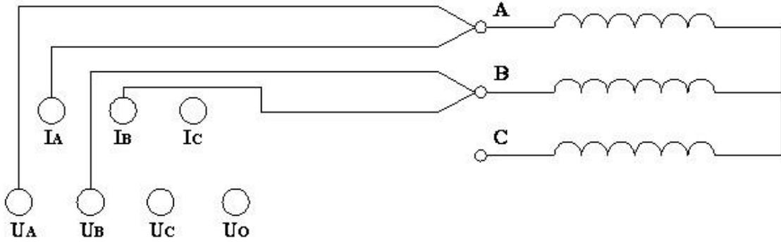
接好被测绕组接线，选择合适的测量电流后，按“测量”键，直阻仪进入测量状态，开始给绕组供电。并进入如下界面：
